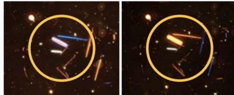
偏光板を挿入し、回転させた時の色の変化
