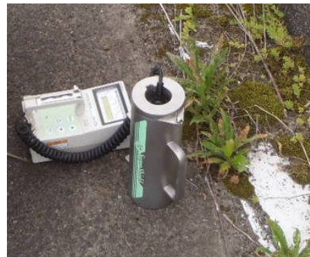
図-4 鉛遮へい具を用いた表面線量率測定状況
