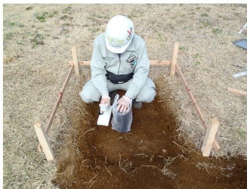
図-3 RSM 遮へい具を用いた表面線量率測定状況
