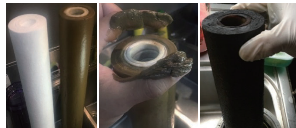
▲ベトナムにて、純水器のメンテナンスを行った際のフィルター（左：使用前、中央・右：使用后）
