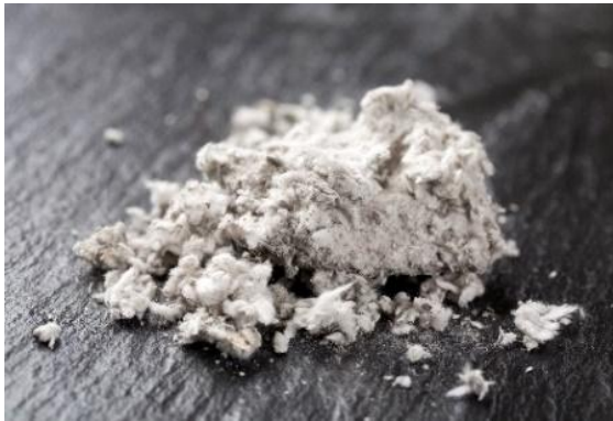
図1 アスベスト写真例
